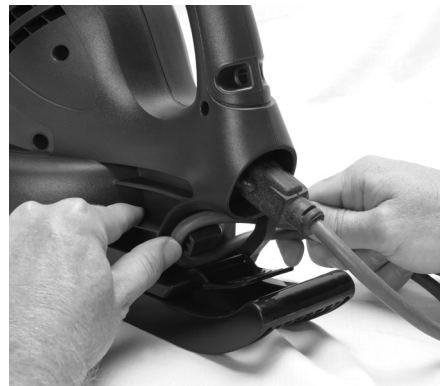
Figure 4-3 : Tirez sur la boucle pour l'insérer solidement dans le dispositif de retenue
